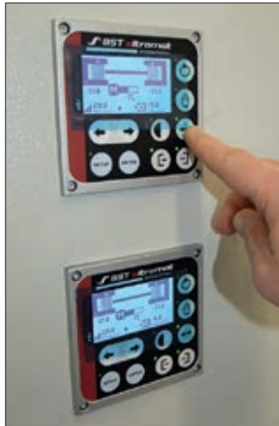
Die Bedienung der CompactGuide-Bahnlaufregelungen über ihre Regelgeräte ist dank der logischen Benutzerverführung ausgesprochen einfach.
