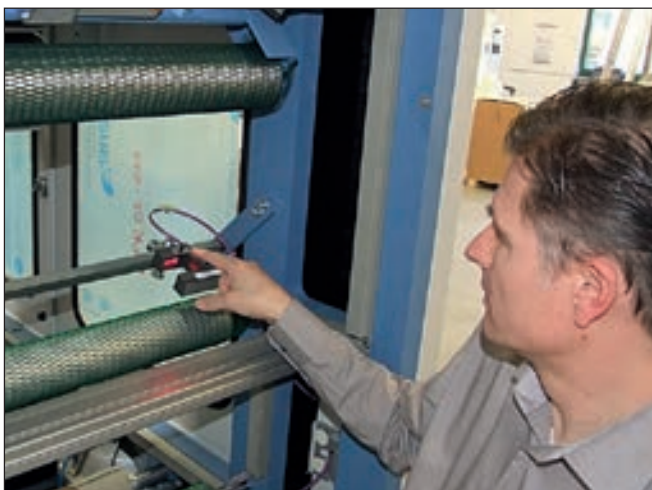
Bei Maschinen, die Tissue-Materialien verarbeiten, wird die Bahnlaufregelung CompactGuide mit zwei Infrarotsensoren ausgestattet.
